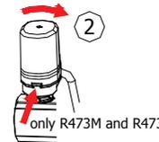
Per poter effettuare la regolazione si procede all'apertura completa della memoria meccanica utilizzando la parte a cacciavite della chiave R558. Utilizzando poi la parte esagonale della stessa chiave si procede all'apertura del detentore fino al raggiungimento della portata desiderata. Si procede poi alla chiusura della memoria meccanica utilizzando la parte a cacciavite della chiave R558.
